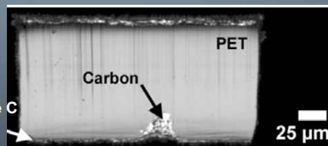
Microelettrodo di carbonio flessibile (Sezione trasversale)
